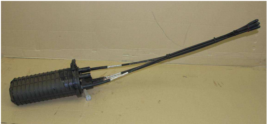
Rys. 22. Osłona po zamknięciu i próbie szczelności pneumatycznej.
