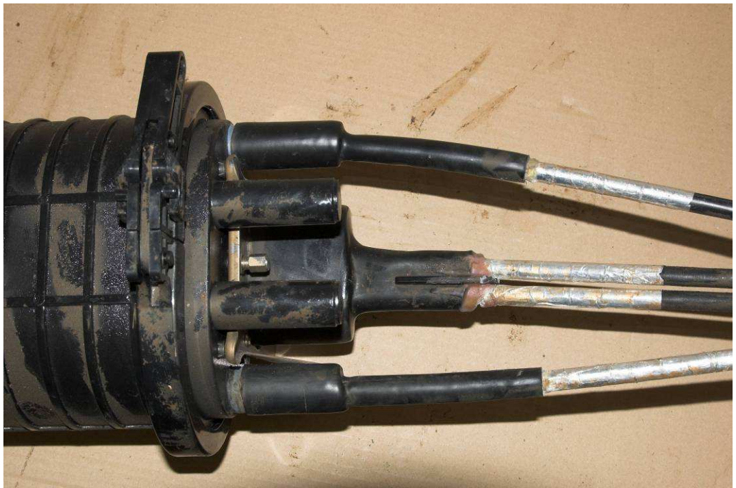
Rys. 14. Wygląd osłony po zginaniu kabla.
